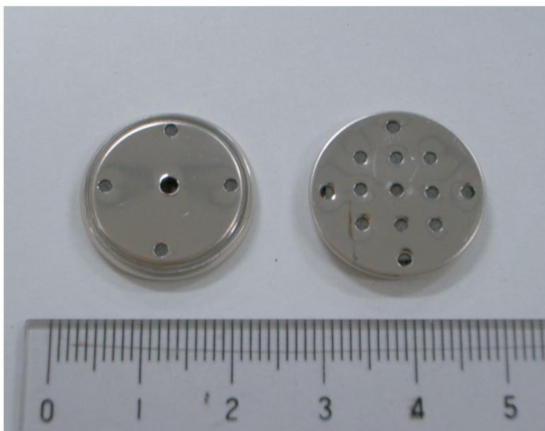
左：負極側、中央に燃料供給口 右：正極側、複数の空気孔
