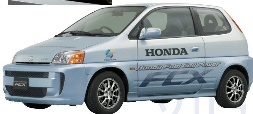
燃料電池自動車(FCV)への参入は後発ながら、実用化へ向けた動きが最も進んでいるのが、本田技研工業である。2002年から2005年6月中旬までに日米の合計19台を納車したほか、同年6月29日には、アメリカで世界初となる個人ユーザーへの納車(リース)を行った。最大出力86kWの固体高分子型燃料電池を搭載し、燃料には圧縮水素ガスを使用して、109馬力(80kW)の交流同期モーターで前輪を駆動する。燃料電池が苦手とする低温下での利用にも対応し、-20~95の範囲での発電が可能である。2005年6月には、FCVとして、日本初の販売を目的とした型式認定も受けた。
