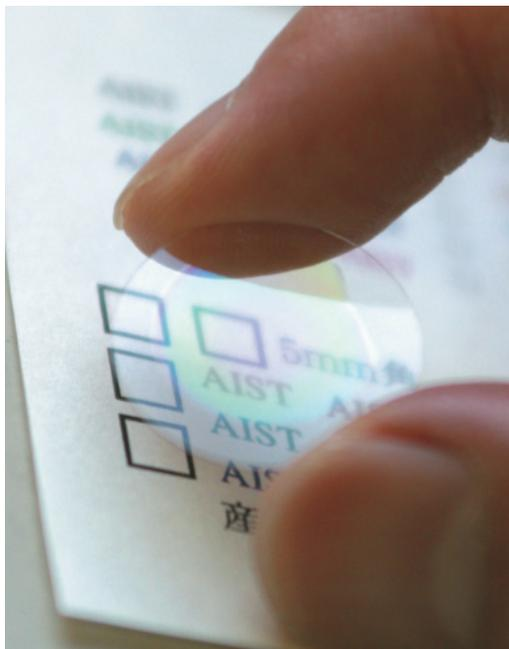
太陽電池は、一般に黒か青、あるいはワインレッドであるが、2003年には、透明な太陽電池の試作に成功している。この透明太陽電池は、青色光または紫外光で光起電力効果を起こす透明な半導体をガラス基板上に作製したものである。さらに、理論的には、赤外光に対する応答を紫外光や可視光への応答とは独立して、任意に制御することが可能であると考えられる。例えば、窓ガラスの代わりに使用すれば、冬は赤外光を通し、夏は赤外光を反射するように設定することで、暖房や冷房を効率的に行うことができるようになり、太陽光発電だけでなく、省エネ装置としても利用できるようになる。
