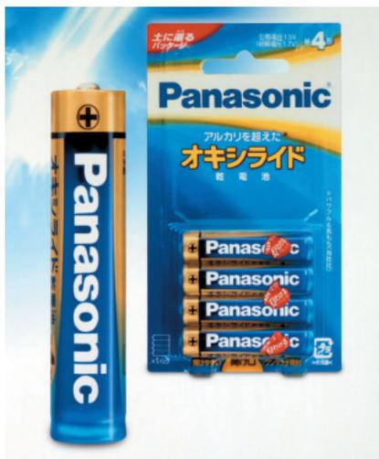
1964年にアルカリ乾電池が発売されて以来の新しい高性能乾電池として、2004年に発売された。正極材料にオキシ水酸化ニッケルを新たに採用したほか、新開発の黒鉛と二酸化マンガンを採用するなどにより、電池容量と出力が大きくなり、連続して1,000mWを出力した場合、出力電圧が0.9Vに低下するまでの時間が同社のアルカリ乾電池と比較して約1.5倍に伸びている。特に大きな電流を必要とする機器に最適で、デジタルカメラでは、撮影枚数がアルカリ乾電池だと144枚のところ、オキシライド乾電池だと315枚と、2倍を超えている。
