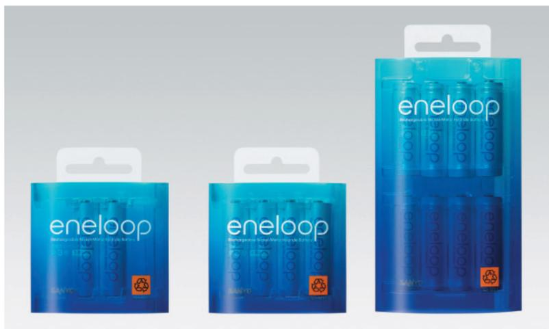
乾電池の代わりに使える充電電池として普及しているニッケル水素充電電池は、電池容量が大きい、寿命が長い(繰り返し使える)などの特長がある一方、自己放電が大きいと、電池容量が、半年で約75%、1年で再充電をしないとほとんど利用できないレベルまで減少してしまう。購入したら、まずは一度充電してから使い始める必要があり、不利であった。eneloopでは、負極材料の超格子合金の高性能化などにより、自己放電後の電池容量を半年で約90%、1年で約85%と、乾電池に対抗し得るまで放電を抑えた。また、繰り返し使える回数も、かつての500回程度から1000回まで向上させている。
