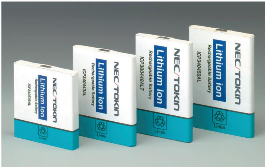
経済産業省の統計によれば、2004年の充電電池の国内総生産金額の53%、国内総生産個数の52%をリチウムイオン充電電池が占めており、金額でも個数でも第1位である。リチウムイオン充電電池の場合、ニッケル水素充電電池とは異なり、汎用品はなく、携帯電話やデジタルカメラなどの、それぞれの機種ごとに専用の充電電池が販売されている。NECトーキンの角形リチウムイオン二次電池は、世界で初めて、正極材料にコストの高いコバルト酸リチウムではなく、スピネルマンガン酸リチウムを使用し、コストダウンを実現した。また、コバルト酸リチウムでは必要だった過充電防止回路も不要とした。
