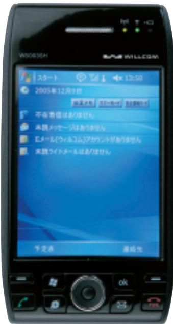
3.7インチモバイルASV液晶を搭載。解像度はVGA(640×480ドット)で、一般的な携帯電話の4倍の情報を一度に表示できる。
