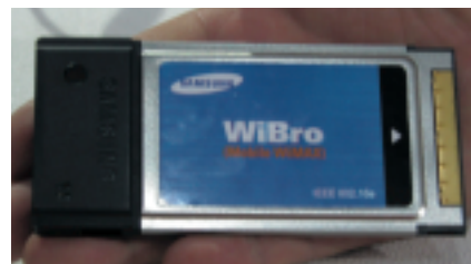
写真 4 : 世界初の WiBro(モバイル WiMAX)用の PCMCIA カード。
