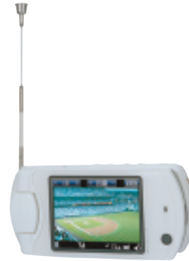
図5 NTTドコモのワンセグ対応端末P901iTV(パナソニック製)。データ放送からパケット通信を使ってウェブサイトアクセスし関連情報を取得できる。
