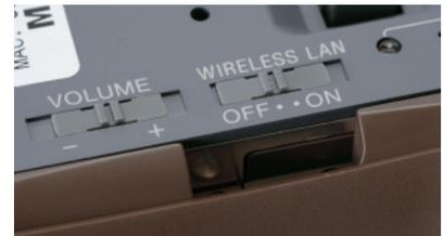
腹部のカバーを外すと、バッテリーやメモリースティックのスロットとともにワイヤレス LAN スイッチと音声のボリュームがある。
