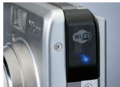
側面に、無線LANアンテナを搭載。下部には、ワイヤレス転送LEDが用意されており、接続状況を確認できる。
