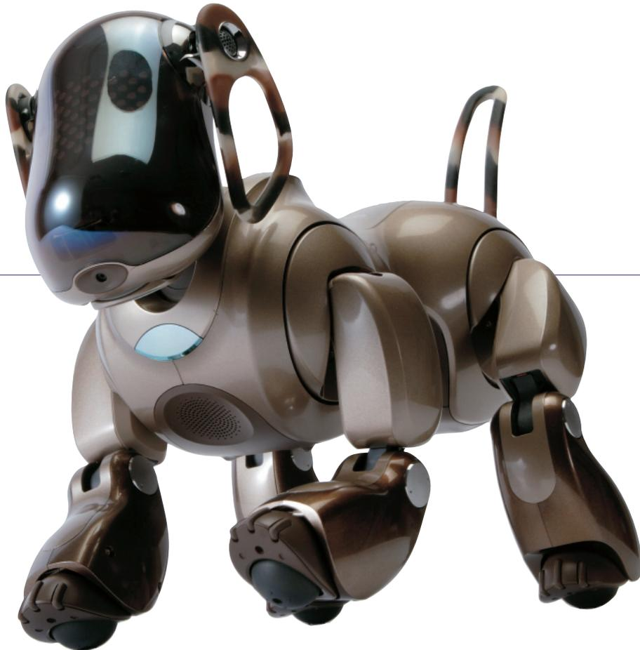
**ERS-7M3** は、自律型エンターテインメントロボット「AIBO」の最新モデルだ。ハードウェア自体は、2003年に発売された ERS-7 や 2004年に発売された ERS-7M2 と同一だが、専用ソフトウェアが「AIBO マインド 3」に、PC 上で動作する「AIBO エンターテインメントプレイヤー」が「Ver.2.0」にバージョンアップするなど、ソフト面で大きく進化している。ボイスサウンドを標準搭載したほか、短期記憶により、対象物の位置を記憶するマッピング技術なども新たに実現した。
