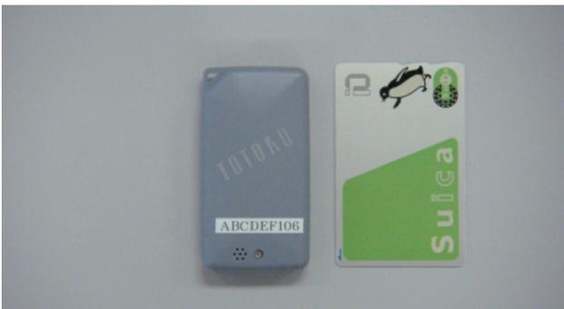
315MHz帯の微弱無線を使用するアクティブ型RFIDタグ「Megras 双方向」は、RFIDタグからレシーバーだけでなく、レシーバーからRFIDタグへの通信が可能である。たとえば部品パレットにRFIDタグを取り付けておき、取り付けた部品パレットが必要になった際、レシーバーから該当するRFIDタグのランプを点滅させたりブザーを鳴らしたりすることで、必要な部品パレットや物品をすぐに見つけられる。消費電力を抑え、5秒間に1回の発信で約1年という電池寿命を実現している。
