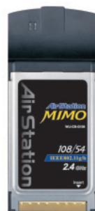
無線LANが普及し始めた当初は、IEEE802.11bが主流で理論値でも最大通信速度11Mbpsと、有線LANを代替するには不十分であった。その後54MbpsのIEEE802.11gが主流になったが、それでも、最も普及している100BASEの約半分ではない。この解決方法として最近注目を浴びているのが、MIMO(Multi Input Multi Output)である。MIMOでは、複数のアンテナを使って送受信を行うため、理論値で108Mbpsという11gの2倍の速度を実現した。また、通常は邪魔者とされる反射波も積極的に活用するので、障害物の多い環境でも安定した通信が行える。しかも、11gと互換性があるほか、MIMO採用のアクセスポイントとMIMO非対応の11gの組み合わせで通信を行った場合でも、通信距離が延びるという。
