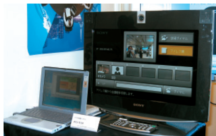
ソニーのビデオ会議システム「PCS-TL50」は20型ワイド液晶ディスプレイ、パン・チルトが可能なデジタルPTDカメラを装備。
