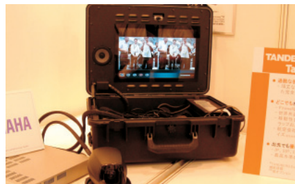
タンバークのポータブル型「Tactical MXP」は、内蔵の多地点接続機能でテレビ会議端末最大4拠点+音声3拠点の接続が可能。
