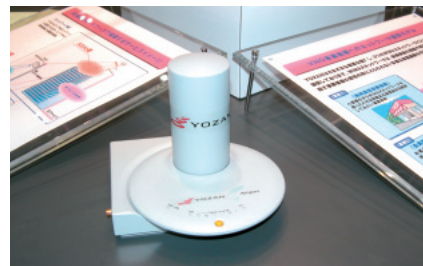
写真6: 「EasyST」は、円筒の部分にWiMAX(802.16-2004規格)の送受信アンテナ、円盤の部分にゲートウェイ用ボードが入っている。
