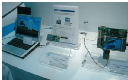
写真11:エスケイネット製のCF型1セグ放送受信モジュール。ウィンドウズXPノートとウィンドウズCE 5.0の試験ユニットに搭載。
