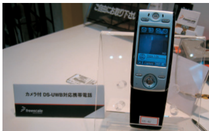
写真10:フリースケールのカメラ付DS-UWB対応携帯電話。UWB通信モジュールはSDIOを介して携帯電話内部に収納されている。
