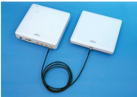
電波法に関する総務省令が改正され、RFIDのパッシブタグ用に952～954MHz帯が開放された。UHF帯用リーダー/ライターとしては、富士通フロンテックの製品が、最も早く技術基準適合証明と構内無線免許を取得した。この製品を使用すれば、免許の申請から取得までが1か月程度で済むほか、無線従業者も不要となるので、UHF帯を使用するシステムの構築が容易になる。通信距離は3～4メートルとのことなので、入出庫検品や物品の所在管理、人員の入退出管理などが効率的に行えるだろう。
