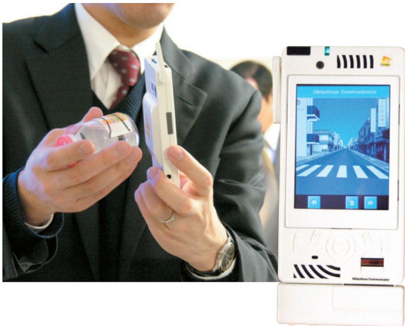
ユビキタスIDセンターなどが関与するRFIDの実証実験で必ず使われている。現在で第6世代となり、着実に進歩している。144×76×15ミリメートル、196グラムのボディに、32ビットRISCを搭載し、VGAサイズのLCD、ステレオスピーカー、30万画素と200万画素のカメラ、指紋認証ユニットなどを備えるほか、13.56MHzと2.45GHzのRFID、無線LAN、Bluetooth、赤外線、SDカード、miniSDカードなどのインターフェイスを備えている。実証実験では、ユビキタス・コミュニケーターで電子タグやバーコードをスキャンし、トレーサビリティ情報や観光情報などの閲覧に使用している。2005年中にも市販が開始される予定で、TRONSHOW2005では、数百台規模でのデモンストレーションが行われた。
