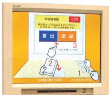
図書やCDなどに電子タグを取り付け、貸し出しや返却の手続きを利用者自身が行えるようにするシステムが、すでに一部の図書館に導入され、稼働している。たとえば貸し出しの際には、貸し出しを受けたい図書と利用者カード(カード型電子タグ)を自動貸し出し機のテーブルに載せるだけで、貸し出し手続きが完了する。そして、出口付近にゲート型アンテナが設置してあれば、貸し出し手続きを経ない持ち出しを防止することができる。また、手間のかかる蔵書点検や書架整理も図書を書架から取り出すことなく行える。
