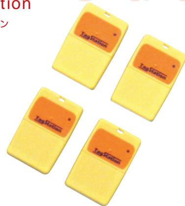
35×53×8.5ミリメートル、15グラムのアクティブタグとリーダーがセットになった製品。300MHz帯を使用し、最大20メートルの通信距離で物や人の所在を管理できる。リーダーを有線LANまたは無線LANでPCと接続する。たとえば、病院で利用する場合、アクティブタグを持った患者の現在位置を、ほぼリアルタイムでナースステーションのディスプレイに表示できる。患者の容体に変化が起きたときは、アクティブタグのボタンを押せば、緊急事態の発生と現在位置が通知される。
