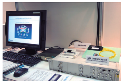
NTTエレクトロニクス「CWDM波長多重送信装置」は2芯光ファイバーで最大8チャンネル双方向通信ネットワークを構築できる。
