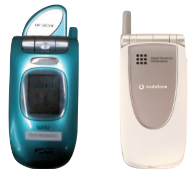
右がボーダフォンの端末(シャープ製)、左は現在開発中の KDDI の端末(日立製作所製)で、上部楕円部分に映像用アンテナチューナーと復調器を内蔵。
