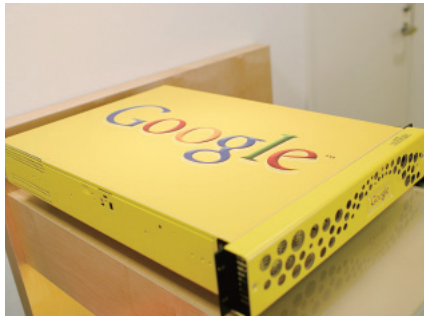
Google 検索アプライアンス。2Uのラックマウント型で社内ネットワークなどで利用できる。
