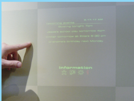
写真2 玄関を入ったところにあるOLEDスクリーン。家族の予定が分かるほか、メッセージを聞いたリ、部屋の温度や音楽を調整したりする。
