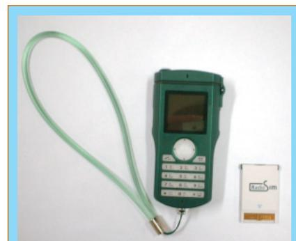
写真1 ジャケットフォンの試作機。右側の四角いモジュールがPHS通信ユニット。今後はおもちゃメーカーなどから多数の「ジャケット」が登場する可能性がある。
