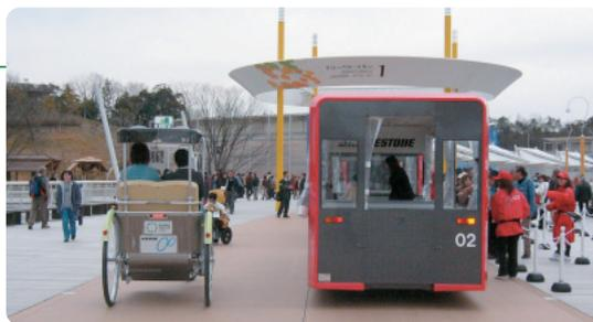
グローバル・ループ上の移動手段として使えるのは、グローバル・トラムと自転車タクシー。グローバル・トラムは、一般の遊園地によく見られる電動のトラムカーだ。グローバル・ループを約半周ごとに停車する感覚なので、ちょっとそこまで行きたいというときには使えない。そういうときには、自転車タクシーを使うことになる。自転車タクシーは、電動アシスト自転車のメカニズムによる三輪車。ヤマハ、ナショナル、ブリジストンがそれぞれ自社の電動アシスト自転車をベースにして万博のために開発したものと、すでに一般利用されているドイツのペロタクシーが使われている。
