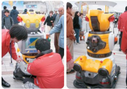
ALSOK(総合警備保障)の警備ロボット「ALSOK ガードロボ」には昼の側面と夜の側面がある。左の写真は昼の側面。撮影時は多少調子がおかしかったらしく、付き添いのスタッフに調整してもらっていたが、胸のタッチパネルで会場案内を行うほか、子供にクイズを出したりする。右が背中にある夜の側面で、警備モード中は火災や不審者を発見すると、通報したり、ペイントボールを発射したりする。
