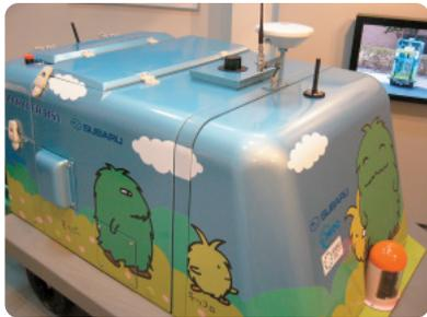
スバルの開発したお掃除ロボット「スバル ロボハイター RS1」。閉場後に、自動的にごみを掃きとる仕事を行う。500ミリリットルのペットボトル程度なら回収も可能。GPS、レーザーセンサー、三角測量により、自分の位置を高精度で認識して自律走行することができる。複数のRS1が特定のエリアを分担して掃除し、終了すると隊列を組んで移動するといったことも可能だ。
