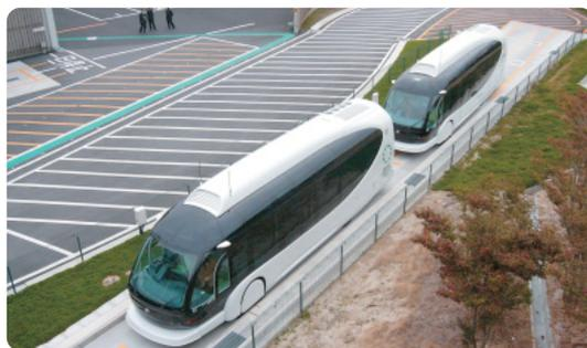
先月号でも紹介したトヨタの開発によるIMTS。バスと鉄道の両方の性格を持っていて、自動運転による効率化と、軌道が道路の中央分離帯などに低コストで設置できる柔軟性が売り物になっている。愛・地球博では天然ガスを燃料としているが、蓄電池を使ったものでもかまわない。
