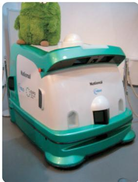
松下電工とアマノの共同開発によるお掃除ロボット「SuiPPi」。内部に格納した地図情報を基に、決められた経路を走行し、掃除する。前面には障害物を回避するためのレーザーセンサーやゴミ検出センサーを持ち、側面には超音波センサーを備えている。また地図情報から自分の位置を割り出すための測位センサーやジャイロセンサーも持っている。
