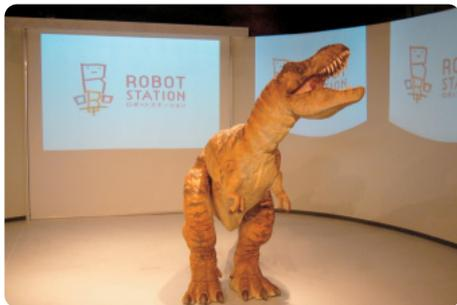
NEDO 技術開発機構と産業総合研究所が共同で開発した2足走行の恐竜ロボット。やわらかい表皮を内部に剛性の高い素材を用いた内骨格構造で、重量の増加を防ぐため、内骨格の素材に炭素繊維強化プラスチックや超軽量のアルミ合金を使ったのがポイントという。動きはかなり滑らかだ。
