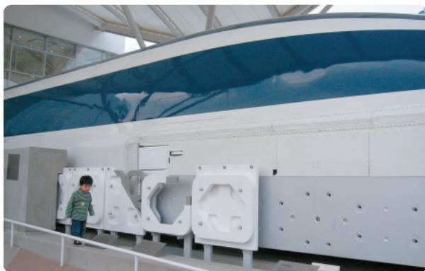
実験で最高時速581キロメートルを記録した超電導リニアモーターカーの実車両(JR東海パビリオン)。側面に見られる超電導磁石と、軌道の左右に設置されたコイルとの間の磁力によって、約30トンの車両を浮上、推進させるようになっている。車内も見られるが、客席部分のみ。座席は、小型コミューター航空機のように、ちょっとさびしい。
