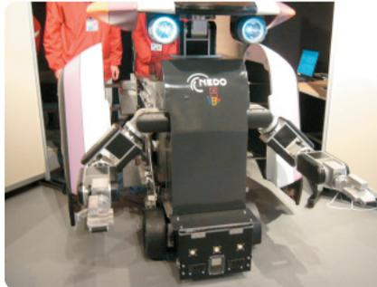
テムザックが開発した「警備・案内ロボット」。肩の部分の色によって、「ムジロー」、「リグリオ」と別の名前がつけられているらしい。こちらも普段は会場の案内をしているのだが、不審物を回収するための頑丈な体とアームを持っているのが特徴。このアームが常時露出していると、人間が触れた際に怪我をする可能性もあるため、通常は側面のカバーに隠されている。マイクロ波と赤外線の人感センサーやレーザーセンサー、炎センサーなどを備えた実用性の高いロボット。
