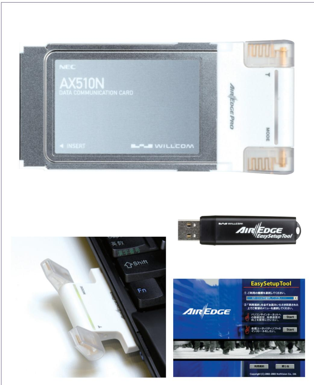
[写真上]AX510Nの全体像。最近のPHSデータ通信カードにしては、スロットより外にはみ出る部分大きい。可倒式で内部が見えるツインアンテナが特徴的だ。
