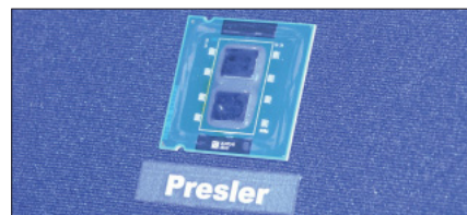
図3 2つのCedermillコアを搭載するPresler。デスクトップ用のデュアルコアCPUとして、今年登場するPentium D/Extream Editionの後継となる。
