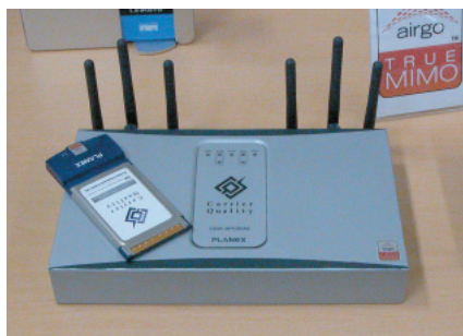
エアゴの MIMO チップを搭載した各社の Wi-Fi (無線 LAN) 機器。左からプラネックス社製、ベルキン社製、ネットギア社製の MIMO 対応製品。
