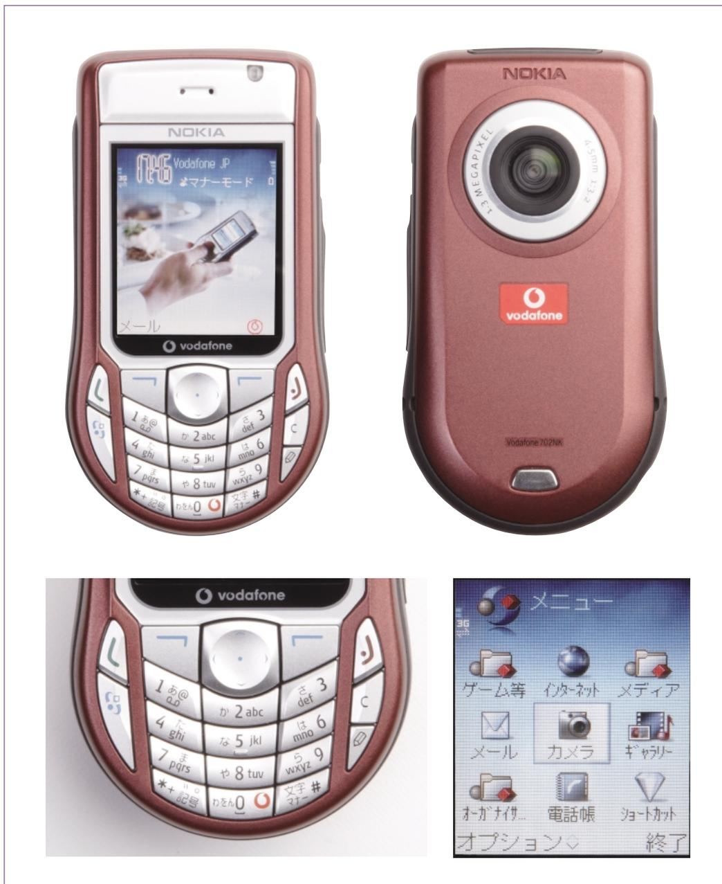
[写真左]Vodafone 702NKの正面。分類上はストレートタイプということになるが、ずんぐりとした外観や、画面がキー部分よりも大きい形状といい、携帯電話というよりもPDAに近い雰囲気だ。電源ボタンは右サイドにある。
