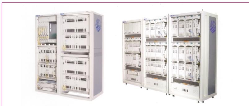
写真1 : NTTドコモの第4世代(1Gbps)向けの実験装置。右側の3架のラックに入っている装置(タテ1.8m xヨコ2.4m)が移動局。これが2010年頃には半導体LSIによって現在のケータイの大きさに収まってしまう。
