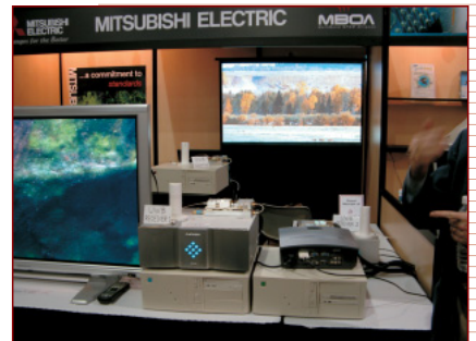
写真 14 三菱電機は MPEG-2 のハイビジョン映像を UWB 伝送装置と UWB 受信装置の間で伝送実験を行った
