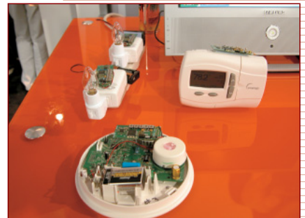
写真 13 ZigBee 半導体チップを使った照明制御用のボード(左上)、空調の温度制御用のボード(右上)、煙検知器用のボード(下)などを展示(フリースケール社)
