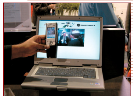
写真 15 フリースケール社は DS-UWB チップセットを携帯電話に搭載。この UWB 内蔵携帯電話(試作機)で撮影した写真を 3.1GHz ~ 5GHz の UWB 低域周波数帯で、110Mbps でパソコンに転送するデモを行った
