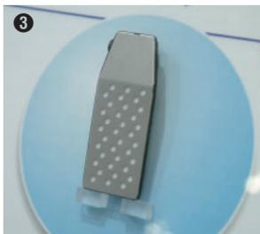
① 富士通研究所のFOMA端末向け燃料電池はクレードル型で、リチウムイオン充電機の充電に使用される。② 日立製作所の燃料電池。携帯電話向けだけでなく数種の電池を展示。写真はノートブックPC用。③ 東芝の燃料電池は今回見かけた燃料電池では最も小さいサイズ。小型オーディオプレイヤー向けに開発されている。
