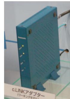
TVアンテナに利用されている同軸ケーブルを使って200Mbps超の通信が可能な「c.LINK」は2005年内の製品化を目標としている。写真は松下電器産業ブースに参考出品されていたc.LINK用アダプター。
