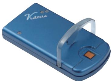
センサーには、保護のために開閉式のカバーが取り付けられている。ハードディスクを取り付けるときは、裏蓋の4本のねじをはずしてケースを開ける。Victoria 120にはフラッシュメモリが内蔵され、ここに指紋認識プログラムや登録した指紋データが格納されている。
