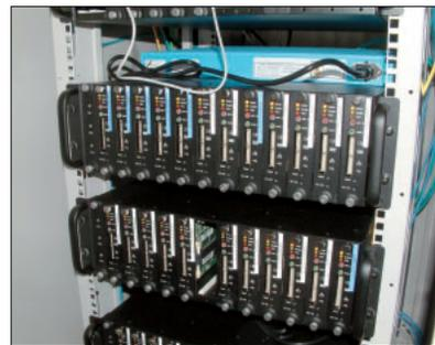
さくらインターネットが使用している超小型のブレードサーバー。4Uサイズのシャーシに10台まで搭載でき、1ラックへの最大格納数は140台。
