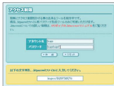
図5 レンタルサーバー「ロリポップ!」の管理ページにある「アクセス制限」ツールでユーザー名「hoge」、パスワード「hohogehoge!!」のhtpasswdを生成しているところ。生成された「hoge:c/fIQ59YkNJVs」という行を、htpasswdファイルに書き込んで保存する(ユーザー名とパスワードによって書き込む文字は変わる)
