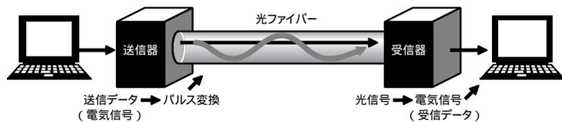
高速な点滅動作が高速・短時間に情報を送る
