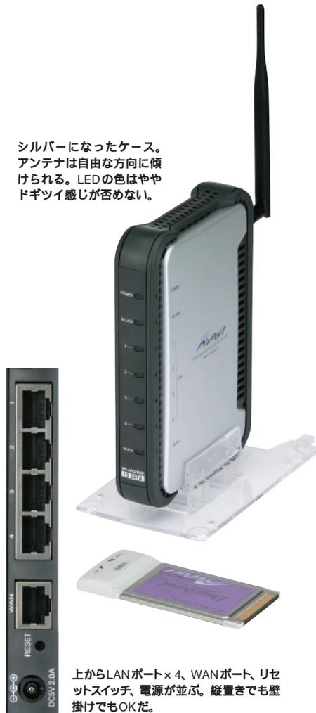
上からLANポート×4、WANポート、リセットスイッチ、電源が並ぶ。縦置きでも壁掛けでもOKだ。
