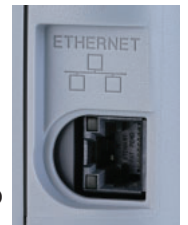
背面に、有線用のLANポート（100BASE-TX/10BASE-T）がある。
