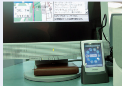
同じ日立のブースで展示されている「超流通」のデモ。コンテンツ自体はSDカードで提供され、そのコンテンツを聞くための鍵データがネットワークで提供される仕組みだ。
