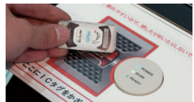
「Motor Info Gate」では、ICタグをリーダーにかざすと、リーダーがタグの番号を読み込んで登録したメールアドレスに情報が送られる。
