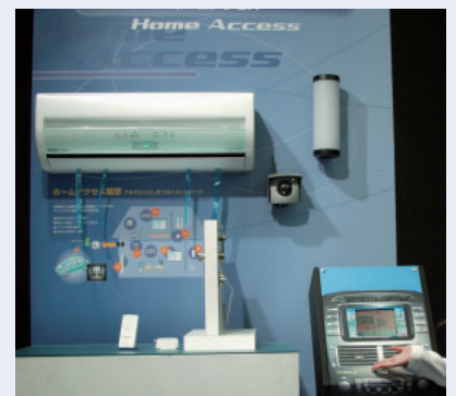
松下電器産業の「エコーネット」を使ったシステム。カーナビから家庭内のさまざまな機器を操作できる。
