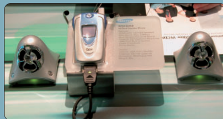
写真3 携帯電話にJBLのスピーカー2本をつないでステレオオーディオを実現(サムスン電子SCH-E250)
