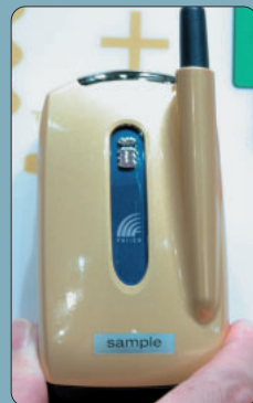
写真13 NTTドコモのユビキタスアプリケーションとして注目を集めた非接触ICカード(フェリカ)内蔵のFOMA端末
