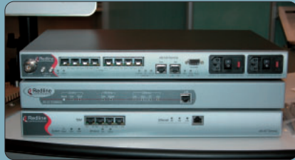
写真19 一番上のボックスが固定無線アクセスの新標準IEEE 802.16aに準拠した「AN-100 PMP System」(レッドライン)
