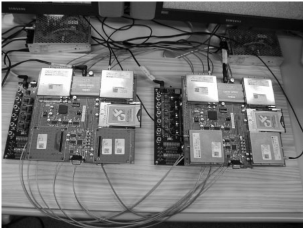
ハイビジョンテレビ10本の信号をリアルタイムで暗号化・復号できるシステムの心臓は、カオスを利用した高速ストリーム暗号用の「VSC」チップだ。乱数列により並列で暗号化の処理を行えるのが高速化のポイント。
