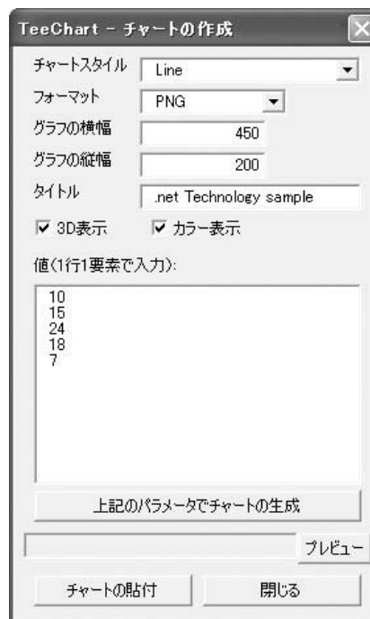
図4 [ TeeChart - チャートの作 成 ]ダイアログボックス。グラフの値 は、図のように1行1要素で入力す る(デモ版の位置付けなので機能 は限られている)
