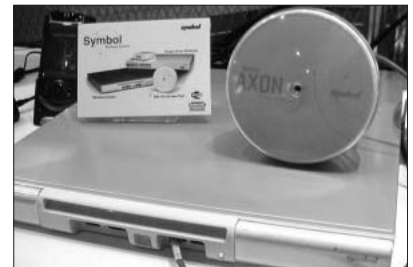
日本シンボルテクノロジーのワイヤレススイッチとアクセスポイント。アクセスポイントの中央でLEDが青く光る。
