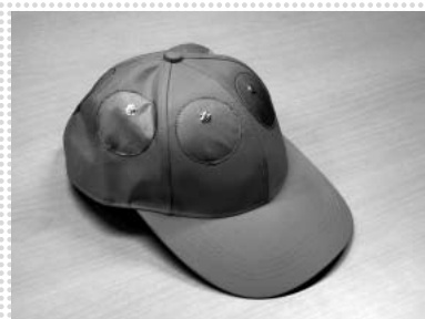
締め切り間近に完成した「帽子アンテナ」の試作品。これで衛星通信ができてしまうとオドロキだ。
