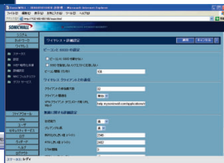
無線LANの詳細設定画面。伝送能力やブリアンブル(本データの前にある定義コメント部分)の長さなどの細かい設定も変更できる。
