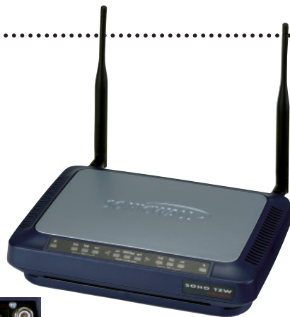
左から電源、WANのステータス、無線LANのステータス、LANのステータスと表示が並ぶ。大き目の無線LAN内蔵ルーターといった感じのケースだ。アンテナが調整できるし、壁掛けもOK。
