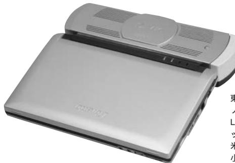
東芝が3月に発表したノートPC用の小型メタノール燃料電池(本体重量900グラム)をLibrettoに取り付けた状態。100ccのカートリッジ(120グラム)で約10時間の発電が可能。米PolyFuel社は145時間連続発電が可能な小型燃料電池を開発中だという。
