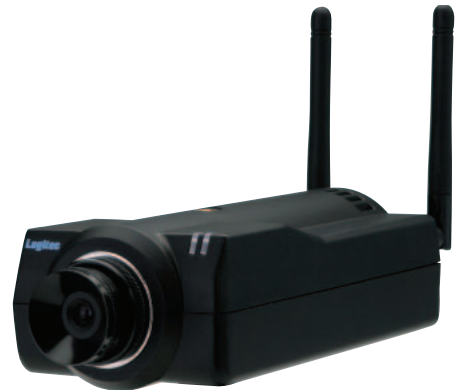
レンズを回してフォーカスを調整する。カメラは下から支える以外に、上下反転し、上から吊すように設置することもできる。
