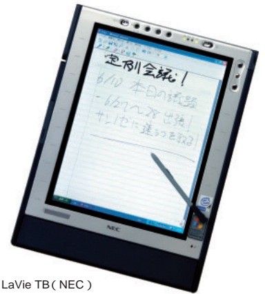
LaVie TB (NEC) OS : Windows XP Tablet PC Edition CPU : ペンティアム 933MHz HDD : 約20GB 価格 : オープンプライス URL http://121ware.com/
