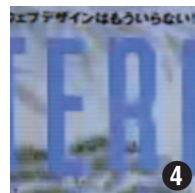
右は静止画の状態。下はすべて静止画に動きを与えた直後の状態(白い紙をカメラの前で動かした)となっている。 ①はTANDBERG 880の768kbpsの静止画像。②はTANDBERG 880 768kbps。③は同384kbps。④は同128kbps。⑤はi・See 128kbpsに動きを与えた画像。同じ128kbpsでもTANDBERG 880とi・Seeではノイズの出方に差が出ている。
