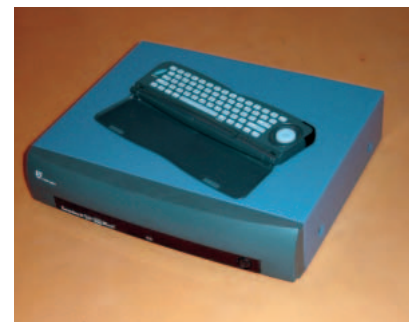
専用のセットトップボックスを利用することで、FTTH経由のコンテンツをテレビで視聴可能。テレビ画面で見たい映画などを選ぶサービスなどが充実している。
