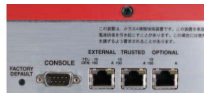
「WatchGuard Firebox 500」の背面。EXTERNALがWAN、TRUSTEDがLAN、OPTIONALがDMZを示す。
