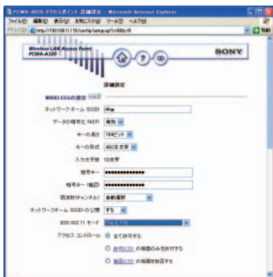
アクセスポイントの詳細設定画面。「IEEE 802.11モード」では、「11gと11b」「11gと11b(高マルチキャストレート)」「11gのみ」が選択できる。
