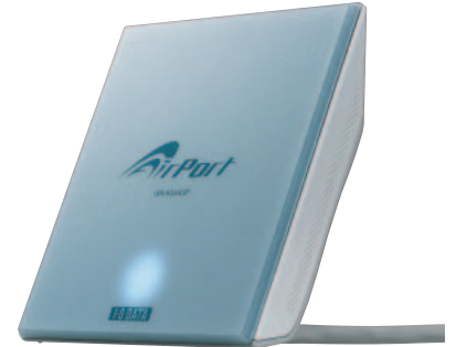
802.11aに対応したアクセスポイント「WN-A54/AXP」は、まったく異なるデザイン。アクセスポイントと電源供給ユニット、有線LANポートが分離されているので、設置の自由度も高い。
