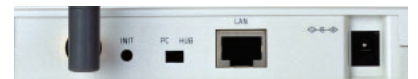
左からアンテナ、設定を初期化する「INIT」スイッチ、LANポートの極性を変えられる「PC/HUB」スイッチ、LANポート、電源ポートが並ぶ。電源アダプターも小型でテーブルタップを邪魔しない。
