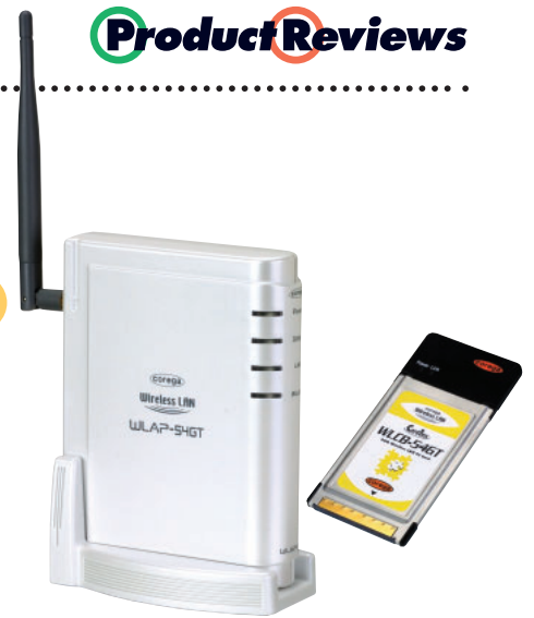
上からPower、Status、LAN、WLANの4つの表示ランプが並ぶ。本体はとても軽くちょっとした場所に設置できる手軽さはGood。
