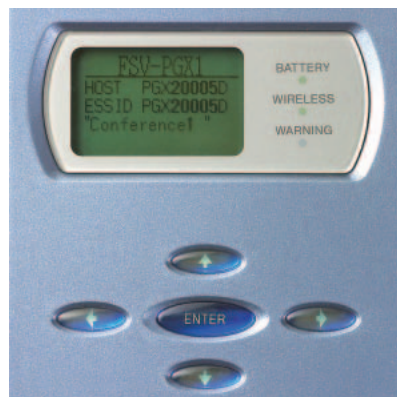
IPアドレスの設定やネットワークの切り替えなどは前面ディスプレイから行える。ESS-IDやホスト名などの情報も表示され、現在の設定情報も確認できる。
