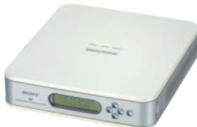
前面液晶では、WAN側に割り当てられたIPアドレスの確認や新規ファームウェアの存在確認などができる。付属のスタンドで縦置きも可能。
