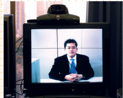
東京と大阪オフィスとの接続デモ画面。両拠点ともBフレッツで接続しているが、写真のViewStation FXではH.323で2Mbpsまでだ。 photo:Tushima Takao
