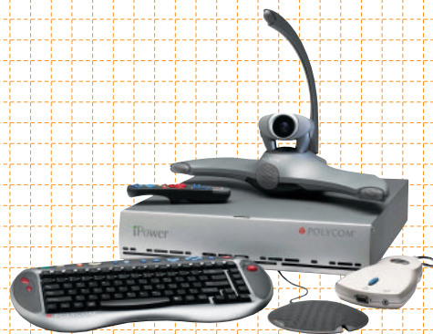
ウィンドウズ 2000の上で動作するiPowerはPCならではのコラボレーションワークに適切。PCの作業画面上に相手を小さく表示したり、作業画面自体をやり取りしたりできる。写真は上位機種種のiPower9800シリーズ。
