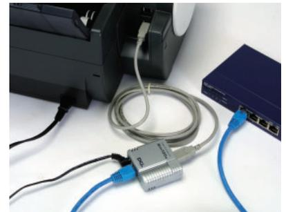
プリンターとMini100uをUSBケーブルで接続し、Mini100uとハブをストレートのLANケーブルでつなぐ。なお、ACアダプターもコンパクトだ。
