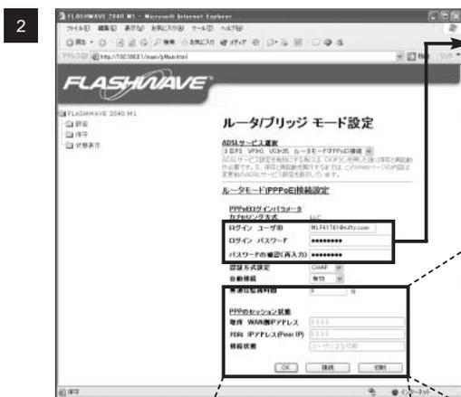
ルーターの接続設定の画面を開き、プロバイダーが発行したADSL接続用の「ユーザー名」と「パスワード」を入力する。そして接続ボタンを押す。
