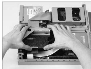
パソコンにLANポートがなければ、LANボードを自分で設置しよう。1,000円程度で購入できる。
