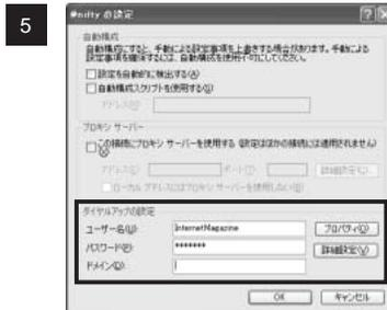
プロバイダーからもらったユーザー名とパスワードを「ダイヤルアップの設定」枠内の「ユーザー名」と「パスワード」に入力し、「OK」をクリックする。「インターネットのプロパティ」の「OK」もクリックする。
