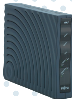
アッカ・ネットワークスの12メガサービスで使用する富士通のADSLモデム。
