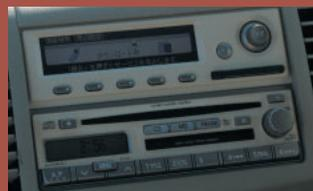
マーチなどの車種に用意されている、1ラジオサイズのカーウイングス用ユニットは、地図情報などを16MBのメモリーカード(CFタイプ)に収録してある。
