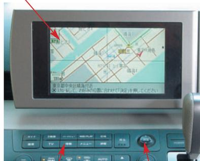
液晶画面の下にあるボタンを使い、カーウィングスのサービスを利用する。数多くのサービスそれぞれを、少ないボタン操作で使えるようになっている。
