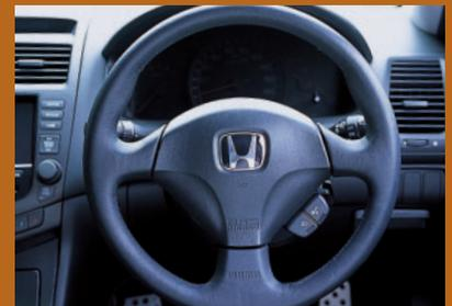
対応車種のハンドルには、操作用のスイッチやマイクが追加されている。複数メーカーの音声認識技術を組み合わせて使用し認識率を高めている。
