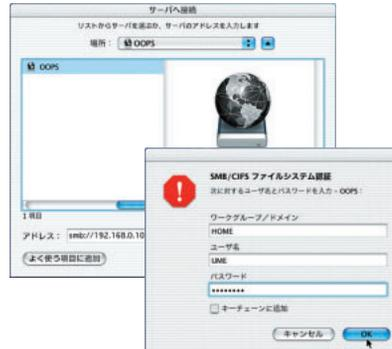
アップルメニューの「移動」「サーバへ接続」を選ぶと、ウィンドウズのネットワークコンピュータ表示と同様に、接続できるPCが現れる。接続しようとする、ワークグループ名、ユーザー名、パスワードを求められる。入力して接続すると、デスクトップに共有フォルダーのアイコンが現れる。
