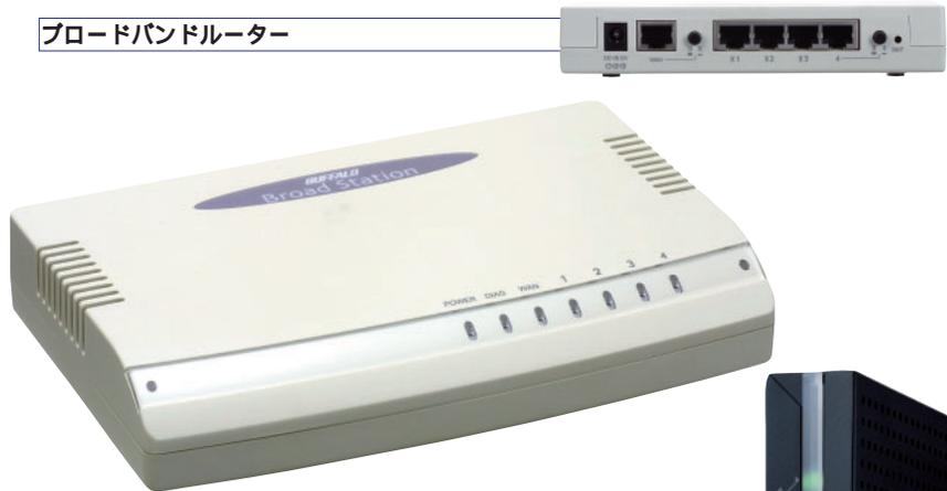
ブロードバンドルーターは最近では二極化が進み、通信速度を向上した低価格タイプと、機能が豊富な高価格タイプに分かれる。写真は低価格タイプのメルコ「BLR2-TX4L」。低価格タイプのルーターについては176ページを参照してほしい。1万円程度。
