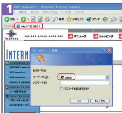
LANにつながったPCのブラウザを起動して、ブラウザの「アドレス」に「http://192.168.0.1」と入力してEnterキーを押す。すると画面のようなウィンドウが現れるので、BLR2-TX4Lの管理者のユーザー名「admin」を入力してOKを押す。
