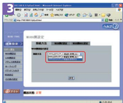
「WAN側設定」の画面が現れるのでインターネット側のネットワークを設定する。LANの設定ではないがADSLで通信するために必要になる。フレッツ・ADSLは「～使用する」を選び、Y!BBは「～使用しない」を選び、「設定」を押す。
