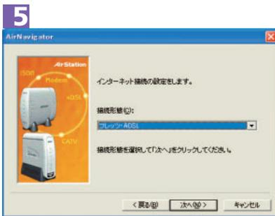
「フレッツADSL」など利用しているインターネットへの接続形態を選択して、ユーザー名やプロバイダー情報、WEPキーなどを設定していく。
