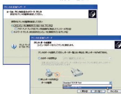
コントロールパネルで「プリンタの追加」を選ぶ。途中の上の画面では「ネットワークプリンタ」ではなく、TCP/IP印刷を利用するので「ローカルプリンタ」を選ぶ。「プリンタポートの選択」では「Standard TCP/IP Port」を選ぶ。
