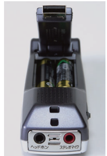
マイクスタンドとして使えるUSBメモリー部は可動式で、水平にすることもできる。電池は本体裏のふたを外して交換する。編み目の部分が内蔵スピーカー。
