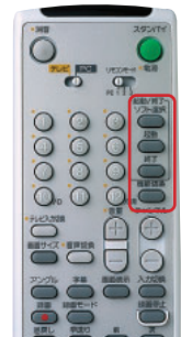
テレビやDVD、音楽プレーヤー機能などを制御できる。右上の囲みは、VAIO Mediaの操作部だ。
